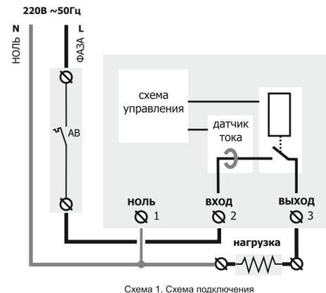
Суммарная мощность всех подключенных устройств не должна превышать максимальную мощность нагрузки прибора. Если мощности прибора недостаточно, необходимо использовать контактор. Для работы прибора необходимо обеспечить надежный контакт в клеммном соединении. Слабо затянутые контакты могут привести к перегреву клемм и проводов, перетянутые - к их повреждению.
