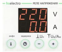
Если напряжение в сети не выходит за установленные пределы (180-250В по умолчанию), через 5 секунд прибор подключит нагрузку к сети, индикаторы перестанут мигать, индикатор **A** покажет действующий ток нагрузки. В дальнейшем при любом повышении или понижении уровня напряжения сети устройство отключит нагрузку, индикатор **V** в мигающем режиме будет отображать уровень напряжения в сети. Нагрузка не будет подключена до тех пор, пока напряжение не нормализуется.
